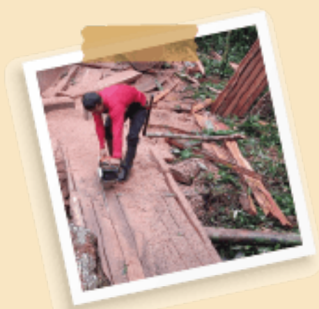
Foto 2. Aserrado de troza de la especie Achapo ( Cedrelinga cateniformis ). Fuente: GGGI, 2022
