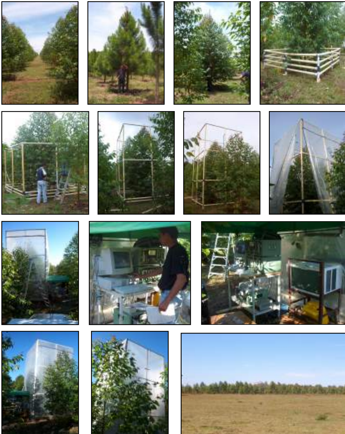
Figura 8. Sistema de intercambio gaseoso para plantas completas ( In situ ).
