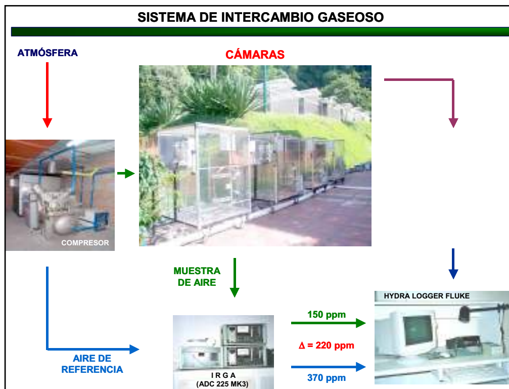
Figura 7. Sistema de intercambio gaseoso para plantas completas ( Ex situ ).
